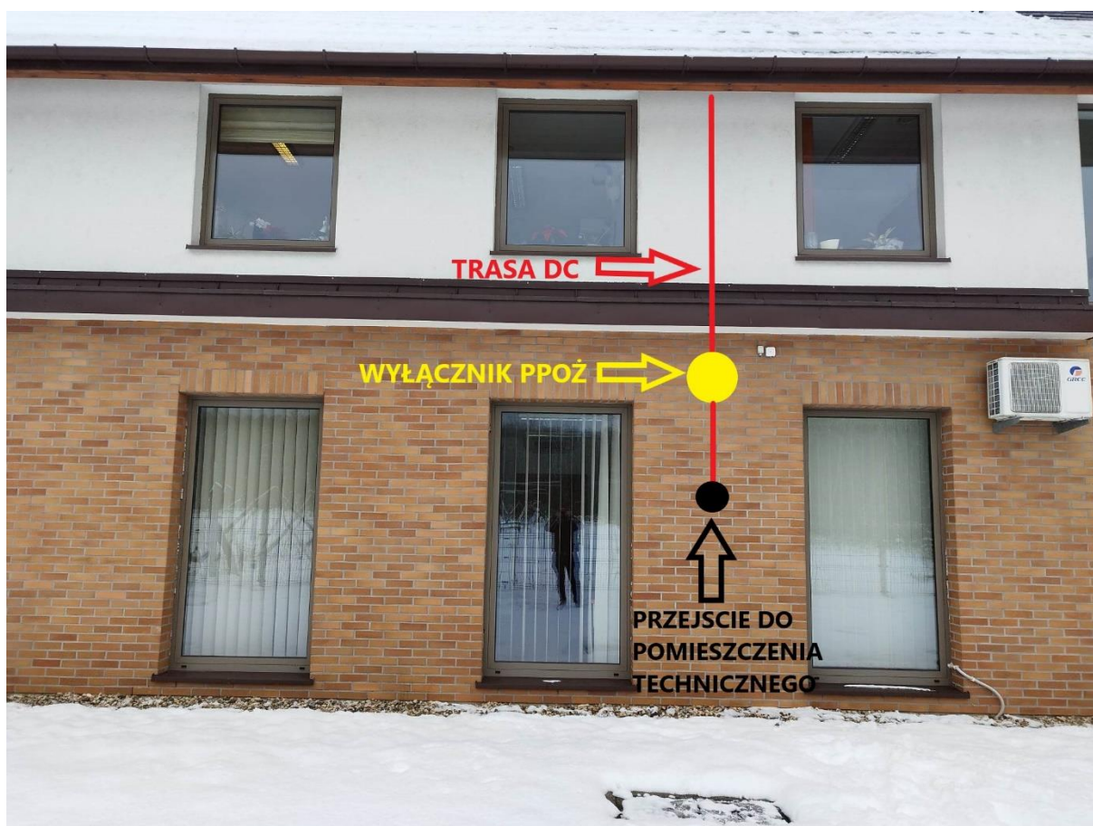
Figura 6 Trasa okablowania DC wraz z lokalizacją umieszczenia wyłącznika PPOŻ oraz planowanego przejścia do pomieszczenia technicznego z lokalizacją falownika.
